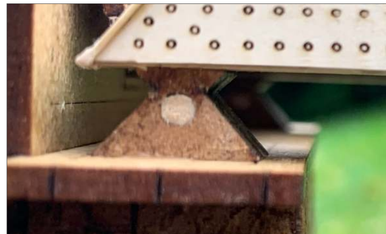
4 supports de positionnement constitués de pièces de 4 mm d'épaisseur relié par un cure dent de 2 mm de Ø.
