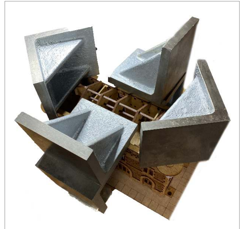
Cuñas metálicas en L ou en T : Ángulos rectos perfectos!
